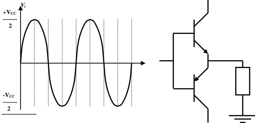
corrente média sobre uma carga  $R_L$  num **semiciclo** de senóide de amplitude  $V$
