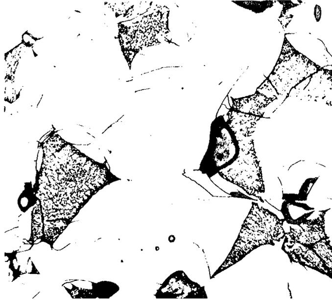
Figura 17 – Microestrutura de ferrita com duas fases. Fase clara é MgFe<sub>2</sub>O<sub>4</sub>, a fase escura (MgFe)O.
