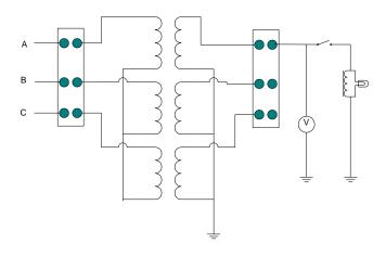
Figura [12]- Ligação de carga monofásica
