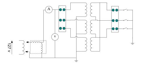
Figura [11] – Ensaio para a ligação ΥΔ
