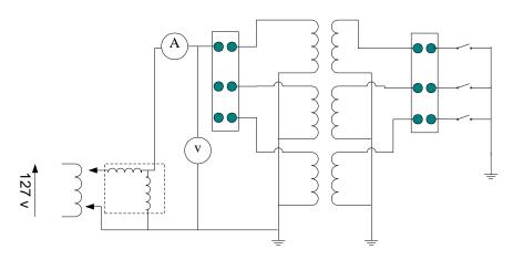
Figura [10] – Circuito para ensaio da ligação YY
