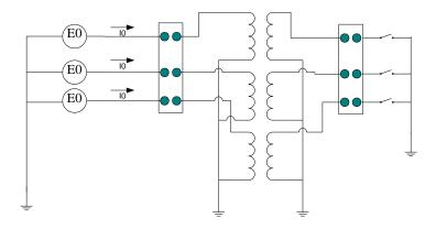
Figura [8] – ensaio para seqüência zero
