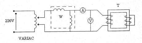
Figura [6] – Ensaio em curto-circuito
