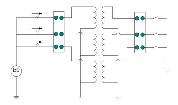
Figura [9] – Ensaio para Seqüência Zero
