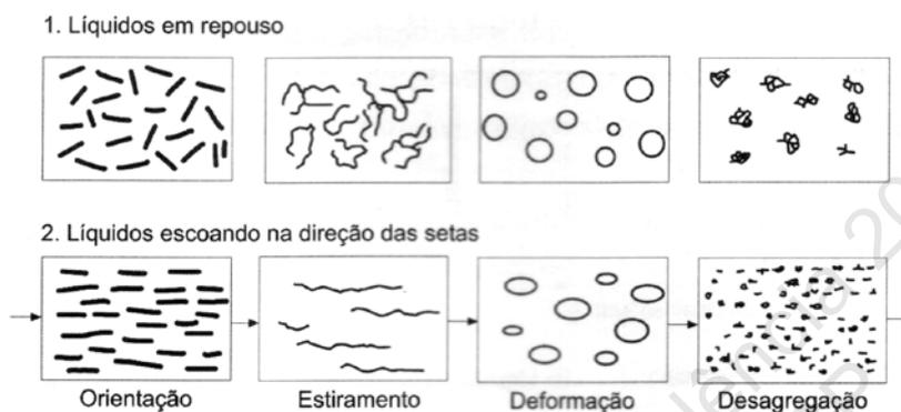
Figura 2.6 – Ilustração de partículas líquidas em repouso e escoando.
