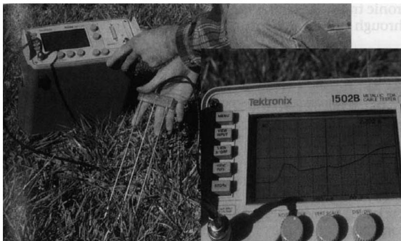
FIGURE 2.15 Medida do conteúdo de água no solo utilizando TDR. O instrumento eletrônico envia um pulso eletromagnético de energia por duas barras paralelas de metal, que o operador está empurrando no interior do solo. O TDR faz leituras precisas, da ordem de picossegundos, na velocidade da qual os impulsos se deslocam nas barras, a qual é influenciada pela natureza do solo. Microprocessadores analisam os padrões de onda gerados e calculam a constante dielétrica do solo. Como a constante dielétrica do solo é influenciada principalmente pelo seu conteúdo de água, o instrumento pode precisamente converter estas medidas em conteúdo volumétrico de água no solo (foto cortesia de Soilmoisture Equipment Corporation, Goleta, Califórnia).
