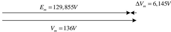
Isso ocorre porque a corrente que passa pelo indutor está adiantada em  $90^\circ$  em relação à tensão do capacitor, e a tensão no indutor está adiantada em  $90^\circ$  em relação à corrente no capacitor, gerando  $180^\circ$  de defasagem entre as tensões no indutor e no capacitor.
