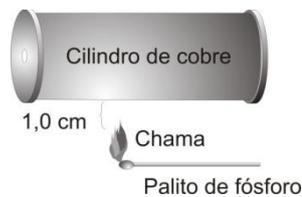
Figura 1. Esquema do aquecimento do cilindro de cobre pela chama do fósforo, que ilustra a distância entre a chama e o cilindro.
