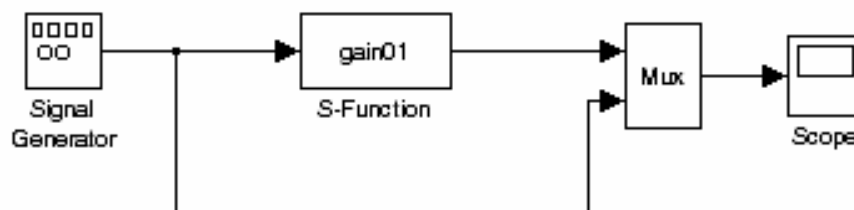
Fig. 2-4: Diagrama para a s-function gain01
