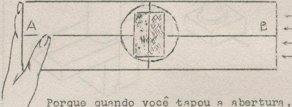
239.- A figura representa o que você observou pelo visor quando tapou a abertura esquerda do fotoscópio.
