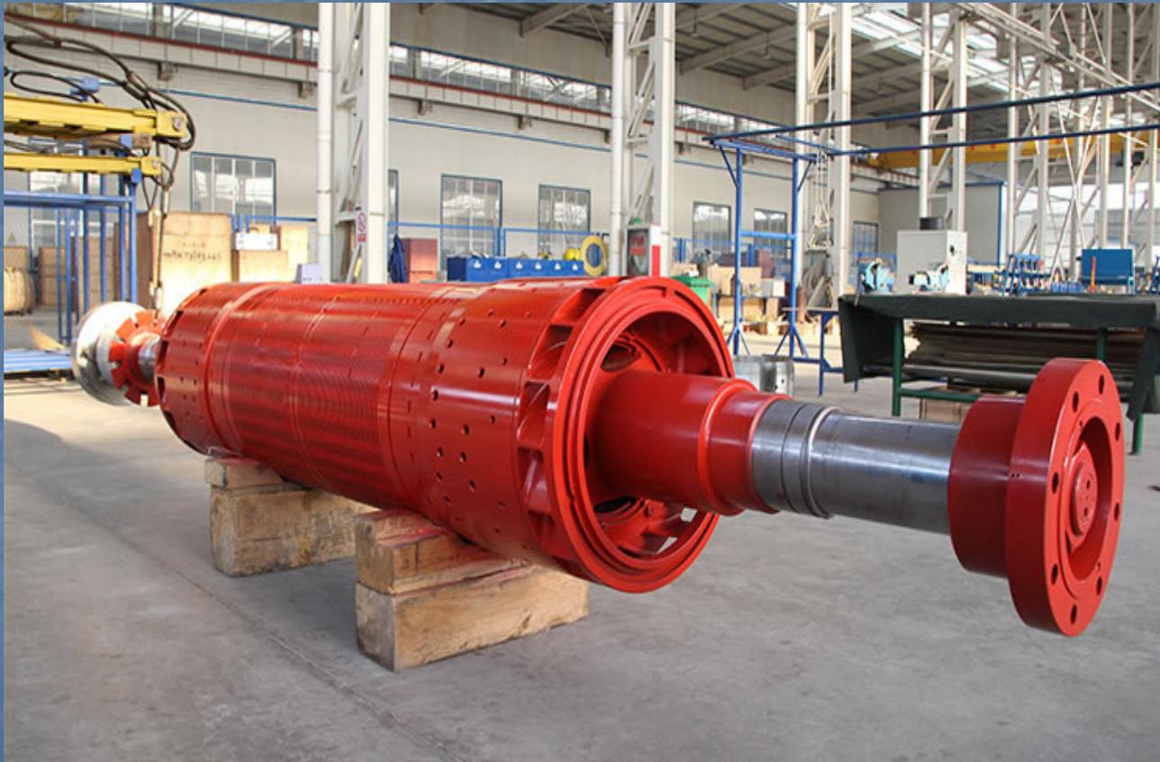
Em geral para geradores de alta velocidade (turbogeneradores)
