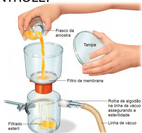
Figura 7.4 Esterilização com filtro, com uma unidade plástica descartável, pré-esterilizada. A amostra é colocada na câmara superior e forçada através do filtro de membrana pelo vácuo, para a câmara inferior. Os poros do filtro de membrana são menores que as bactérias, e assim, elas são retidas no filtro. A amostra esterilizada pode então ser decantada na câmara inferior. Um equipamento similar com discos de filtro removíveis é usado para cortar as bactérias em amostras (veja a Figura 6.18).
