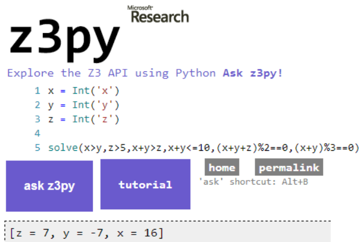
Figura 4.5: Segundo exemplo utilizando o comando 'solve' no Z3PY.
