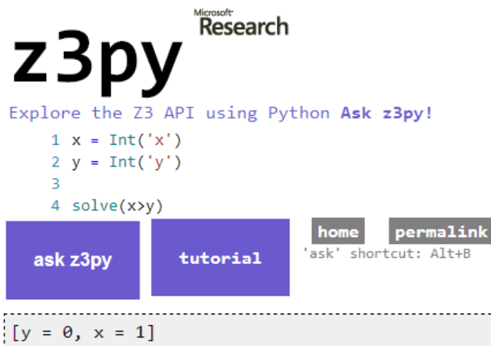
Figura 4.3: Utilizando o comando 'solve' no Z3PY.
