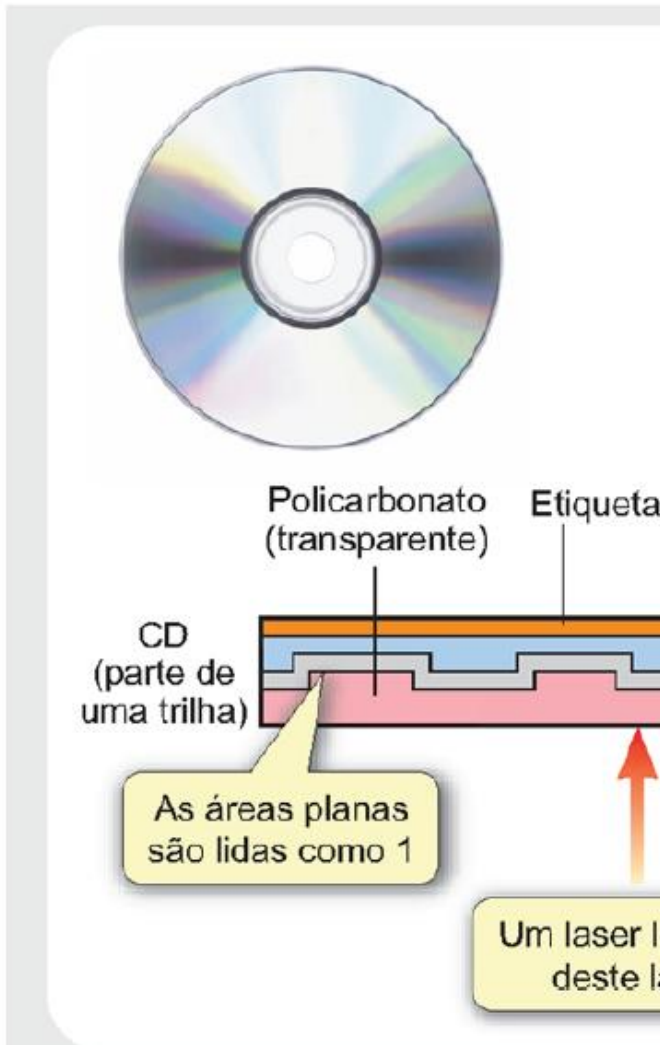
Figura 1 Corte transversal de um disco compacto comercial.
