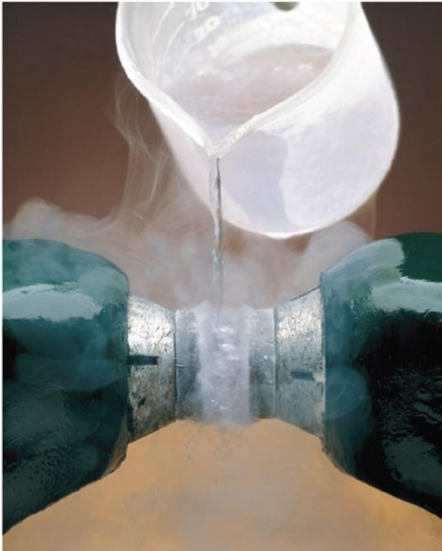
Figura 3.5 O oxigênio líquido é vertido entre os polos de um eletroímã potente. O oxigênio líquido é atraído para o ímã e flutua no ar entre os polos do ímã à medida que evapora.
