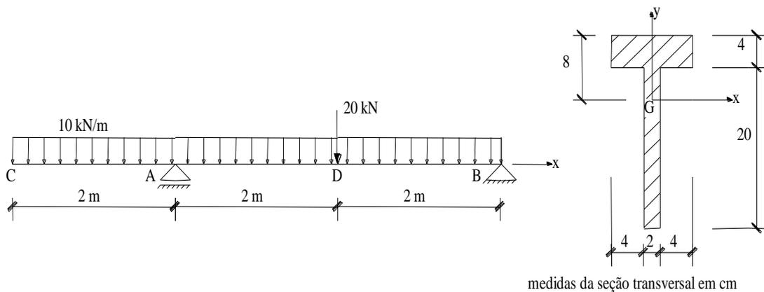
3. Trace os diagramas de esforços solicitantes. Na seção crítica, determine a expressão de  $(\sigma)$ . Determine também as tensões  $\sigma_{\text{máx}}$  e  $\sigma_{\text{mín}}$ .
