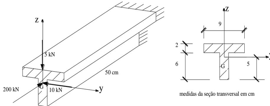
5. Para a viga da figura, determine: a) os esforços solicitantes extremos; b) na seção mais solicitada, a posição da linha neutra; c) as tensões normais extremas ( $\sigma_{\text{máx}}$  e  $\sigma_{\text{mín}}$ ).
