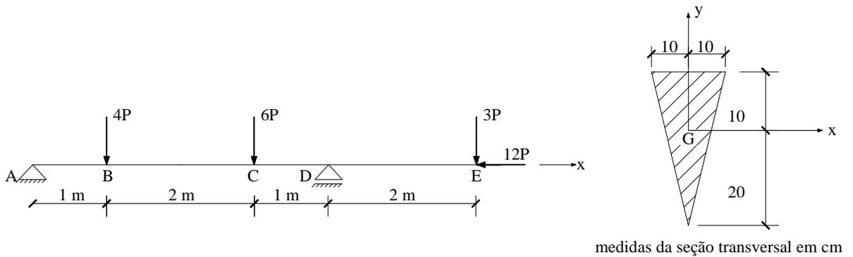
2. Para a viga da figura, determine:
