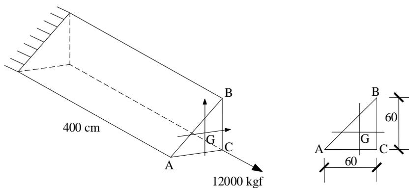
4. Para a viga da figura ( $A = 36 \text{ cm}^2$ ,  $I_y = 204 \text{ cm}^4$ ,  $I_z = 135 \text{ cm}^4$ ) determine:
