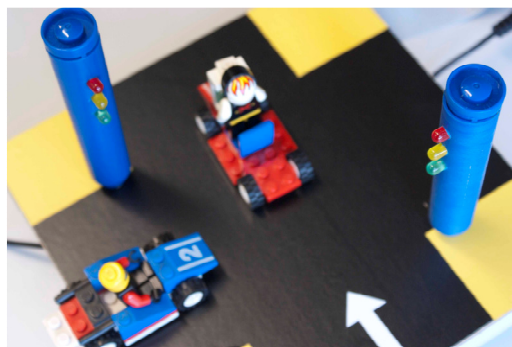
Figura 1 Protótipo semáforo de cruzamento
