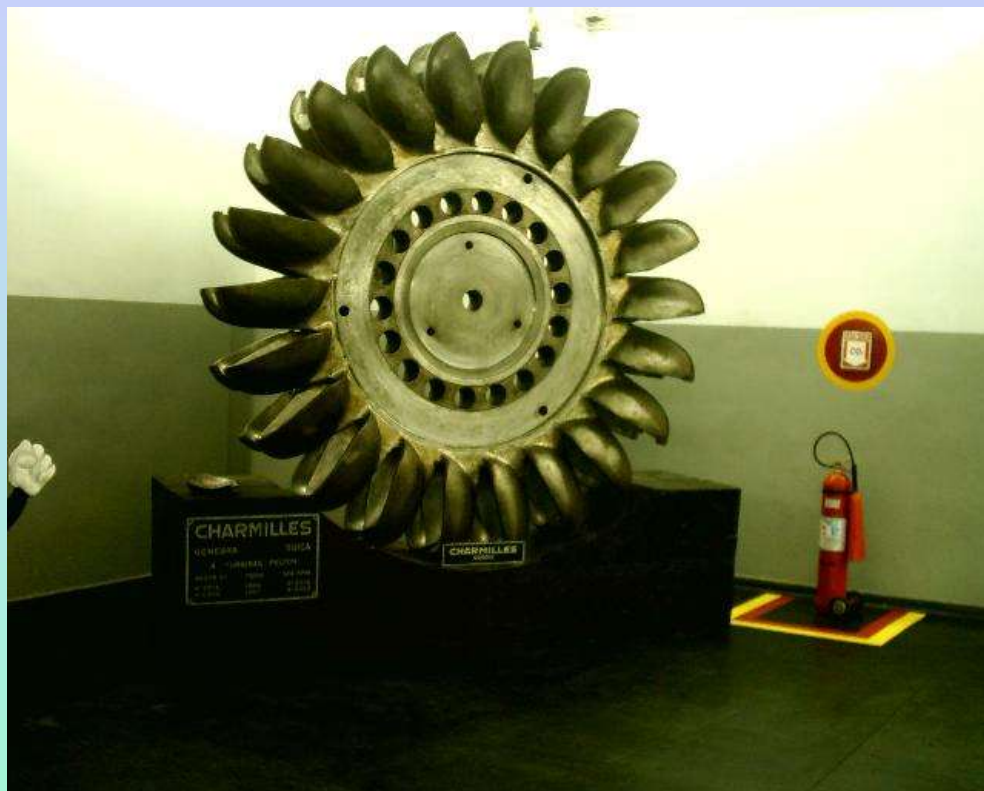
Turbina Pelton desativada na Usina Henri Borden
