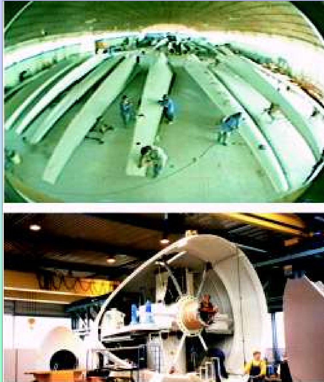
Figura 2.5 – Vista geral da fabricação das pás e montagem da nacela (cortesia Wobben-ENERCON E TECSIS)
