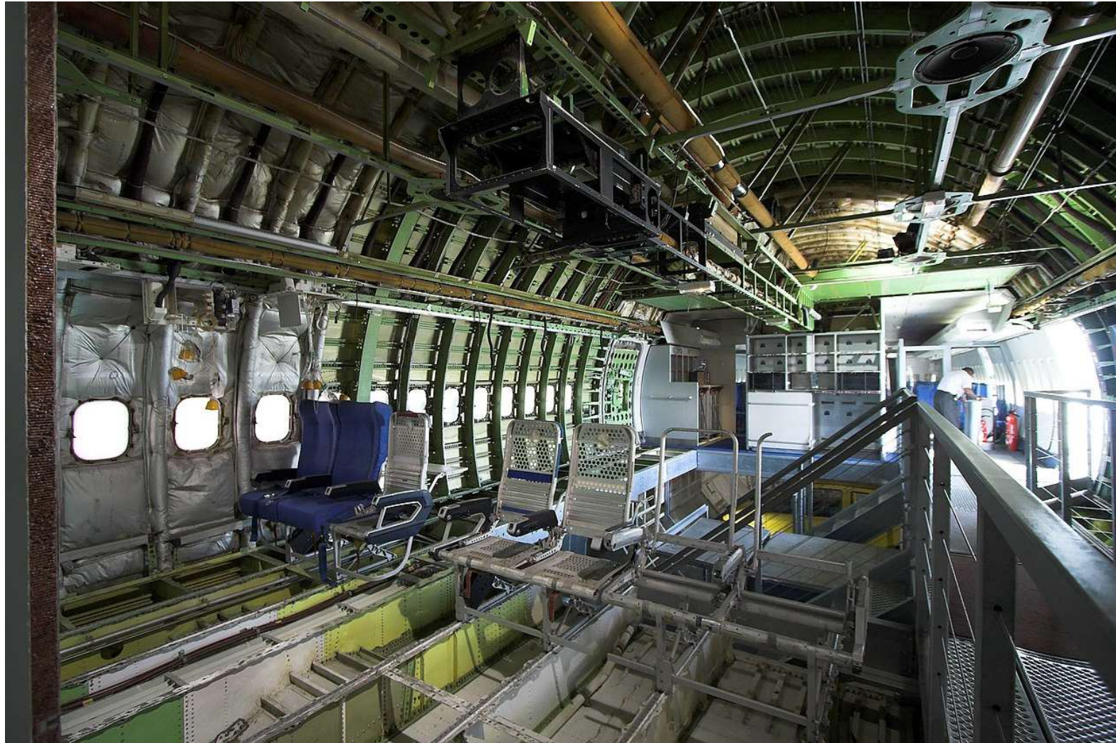
Fig.14: Estrutura semi-monocoque: interior do Boeing 747 [4].
