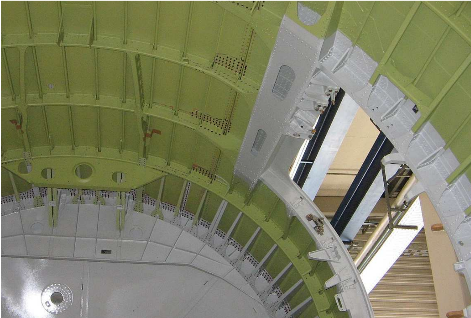
Fig.13: Estrutura semi-monocoque utilizada no Airbus A340 [4].
