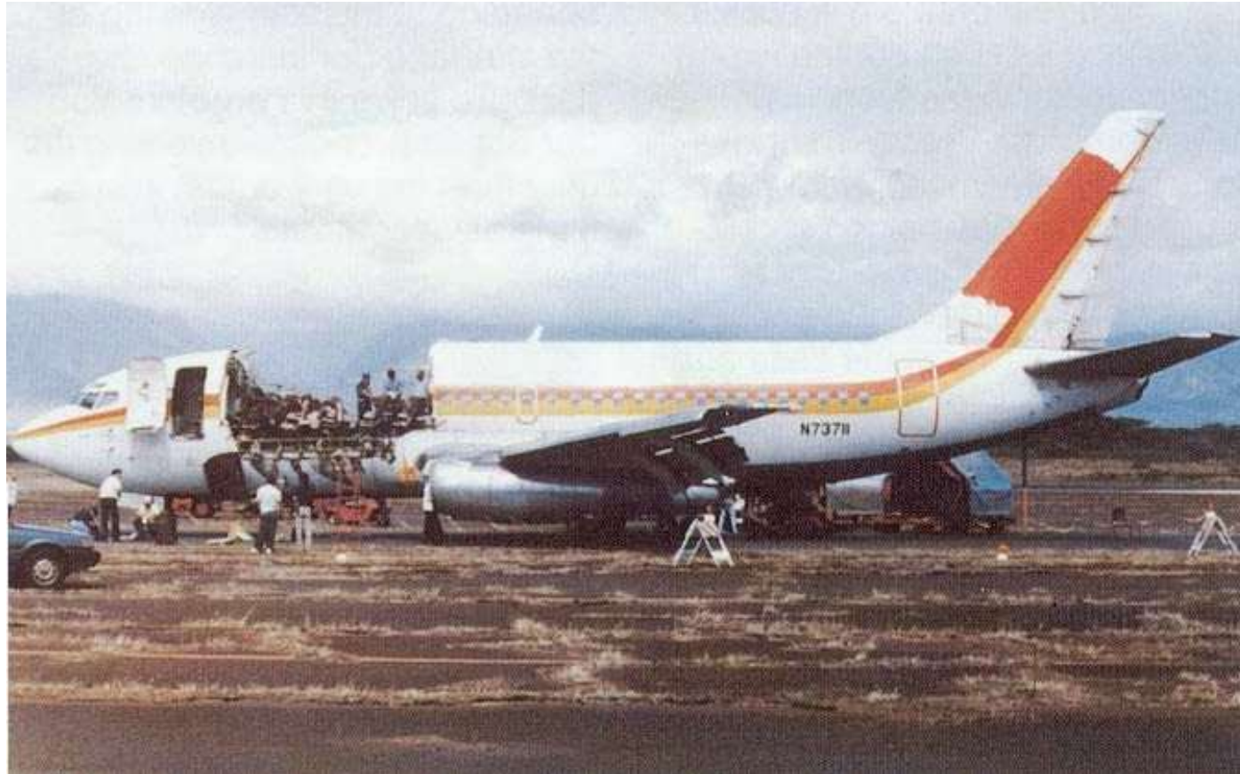
Fig. 2: Falha da estrutura de uma aeronave (Boeing 737) por corrosão e fadiga na fuselagem (acidente ocorrido em 28/04/1988).
