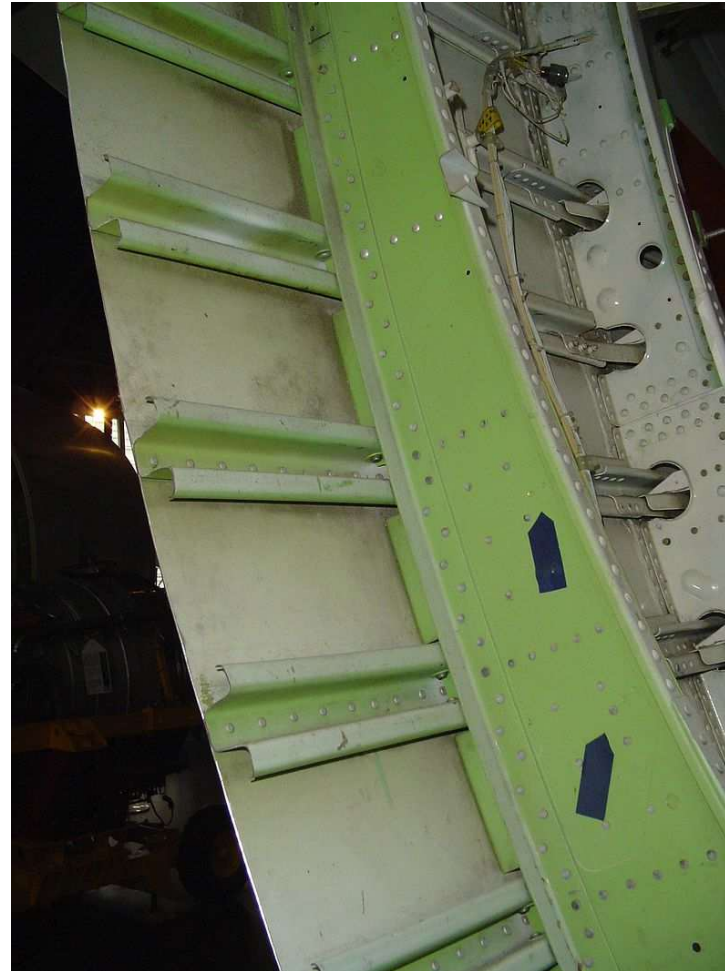
Fig.12: Estrutura semi-monocoque: cavernas (formers/frames), reforçadores longitudinais (stringers) e revestimento (skin) fabricados de alumínio [4].
