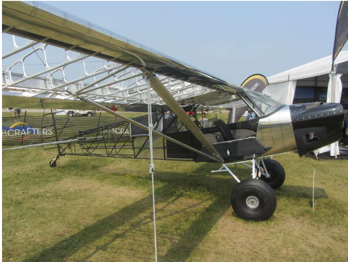
Fig.6: Estrutura treliçada usada na fuselagem de uma pequena aeronave. Fonte: https://commons.wikimedia.org/w/index.php?curid=34782784
