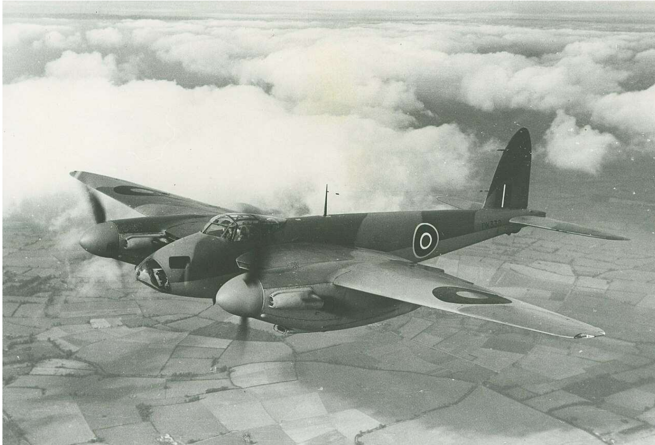
Fig.9: Exemplo de estrutura monocoque: De Havilland Mosquito Fonte: https://en.wikipedia.org/wiki/De_Havilland_Mosquito
