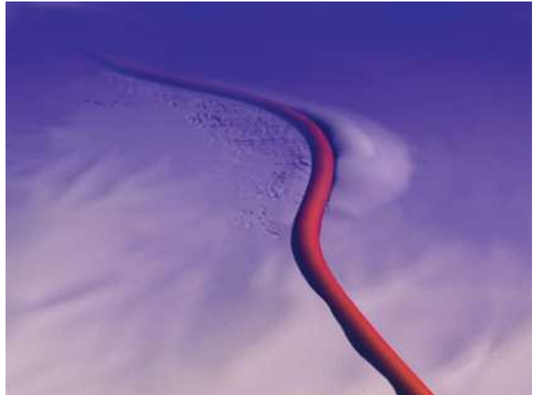
Fig.6: Instabilidade estrutural de dutos (pipeline upheaval buckling, pipeline lateral buckling) [7].
