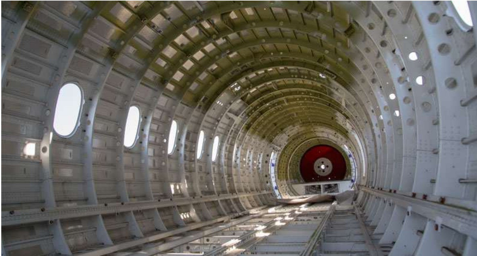
Fig.10: A fuselagem de uma aeronave também deve suportar os esforços decorrentes do diferencial de pressão.
