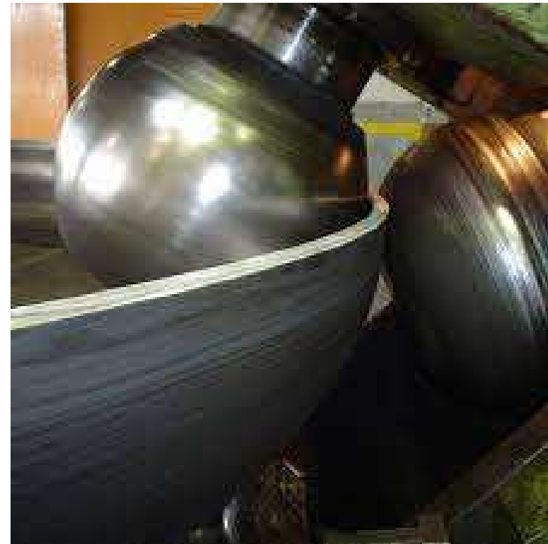
Fig.2: Fabricação de tampos (hemisféricos, torisféricos e elípticos)
