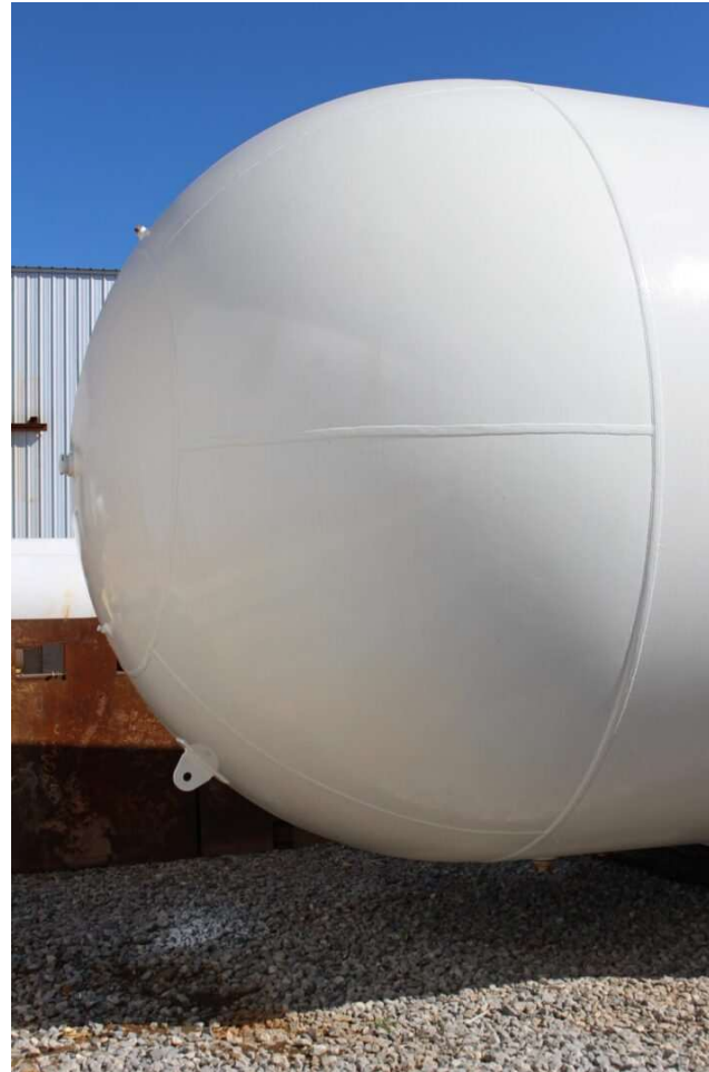
Fig.4: Junção entre tampo hemisférico e vaso cilíndrico.
