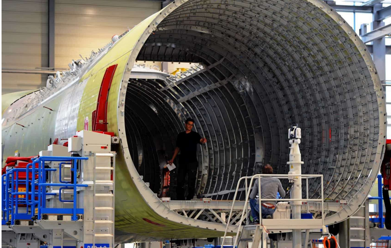
Fig. 6. Cavernas em estruturas aeronáuticas são elementos importantes para aumentar a rigidez e a resistência.
