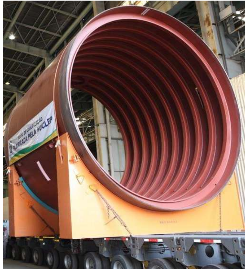
Fig. 7. Cavernas também são utilizadas para aumentar a resistência e a rigidez de submarinos.
