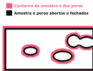
Figura 1 – Esquema dos diferentes tipos de poros em peças cerâmicas
