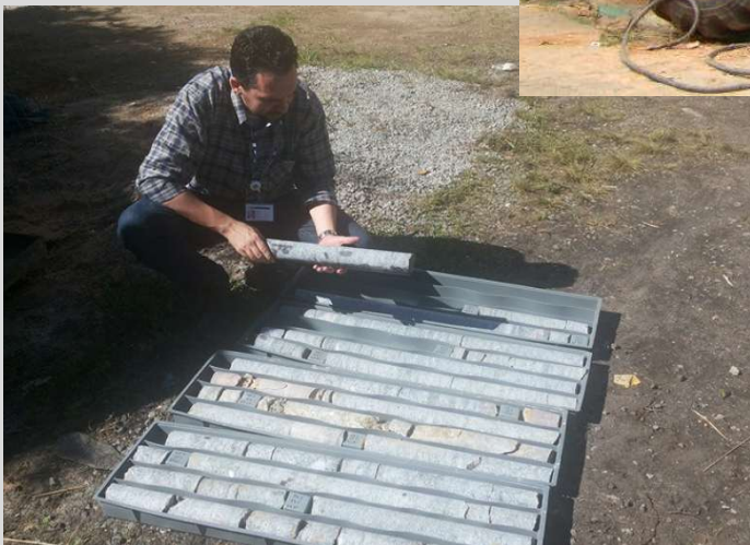
Testemunhos (amostras) de granito-gnaiss (Complexo Embu) – Linha 2 – Verde (Projeto Básico)
