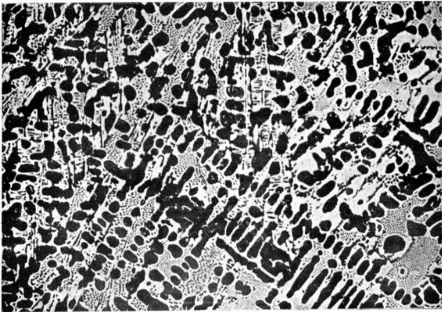
Fig. 523 — Ferro fundido branco hipoeutético. Dendritas de perlita, áreas pontilhadas de ledeburita, áreas brancas de cementita. Ataque: nítrico. 100 x.
