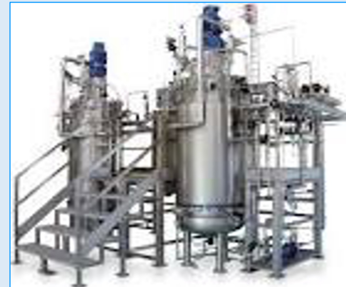
Exemplo de Biorreator de uma planta piloto semi-industrial, com até algumas centenas de litros.
