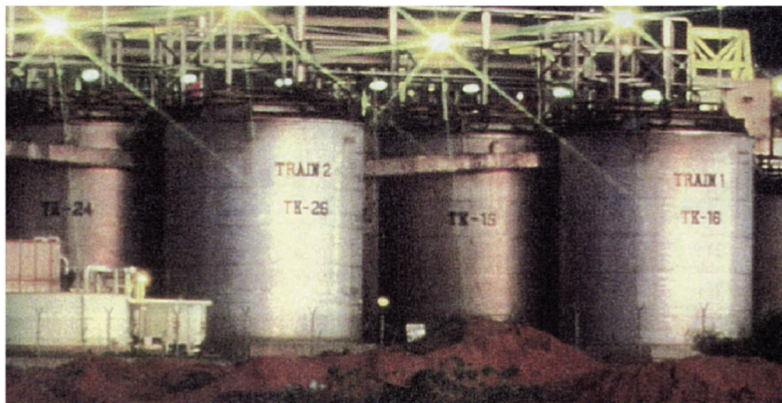
Figura 21.3 Biolixiviação de ouro. Tanques de lixiviação de ouro em Gana (África). Dentro dos tanques, uma mistura de Acidithiobacillus ferrooxidans , Acidithiobacillus thiooxidans , e Leptospirillum ferrooxidans solubiliza o mineral pirita/arsênio que contém ouro, liberando-o.
