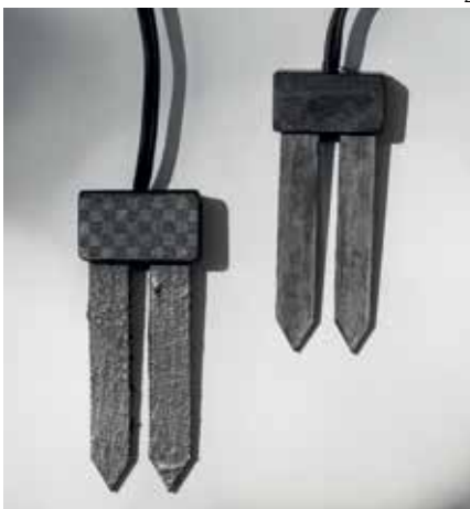
O sensor da Unicamp, com dois eletrodos (acima), foi licenciado para a startup Galemtech. Ao lado, o modelo IGstat durante ensaios em laboratório
