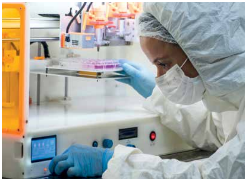
Ana Luiza Millás, da 3DBS, opera uma bioimpressora; em destaque, a seringa que deposita solução com células em compartimentos de uma bandeja
