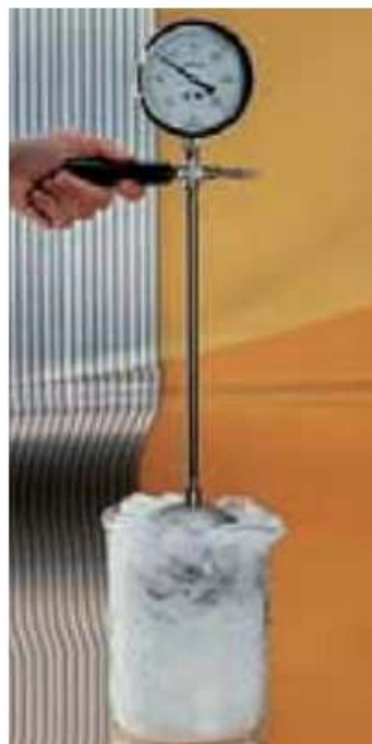
Figura 17.5 (a) Um termômetro de gás a volume constante. (b) Quanto maior a quantidade de gás no termômetro, mais alto é o gráfico da pressão P em função da temperatura T .
