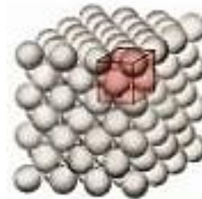
Estrutura Cristalina Cúbica de Face Centrada (CFC)
