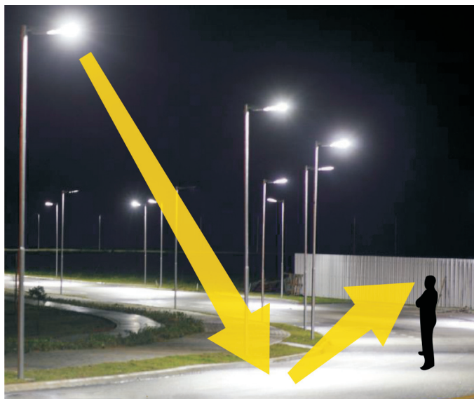
Figura 6.5 - Luminância de uma superfície
