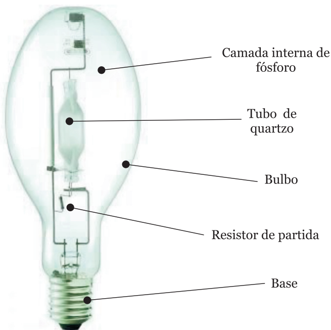
Figura 6.11 - Lâmpada a vapor de mercúrio de alta pressão
