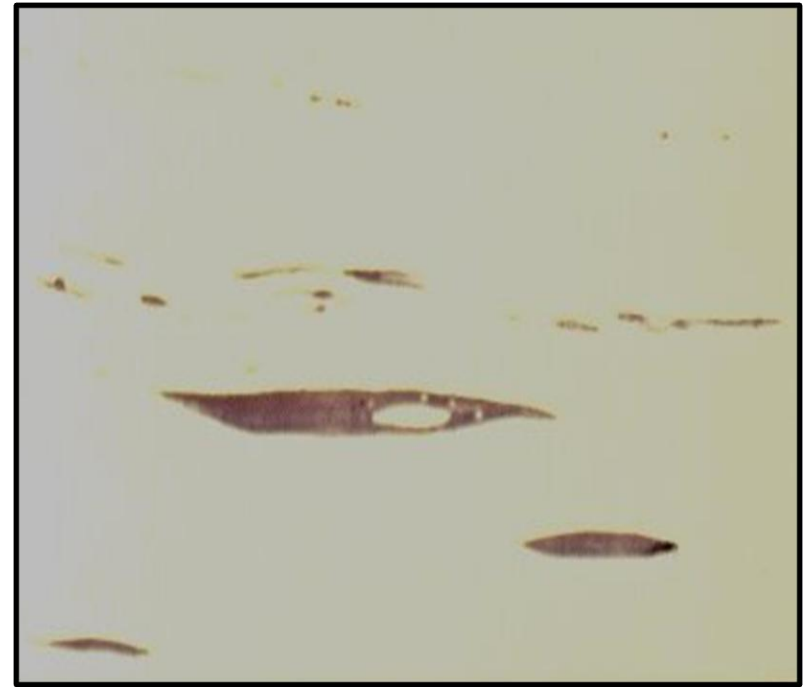
INCLUSÕES DE SULFETO- 1000X
