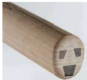
Figura 7 – Detalhes da morfologia e das estruturas em fibra de vidro do barrote da empresa Spieth Anderson.
