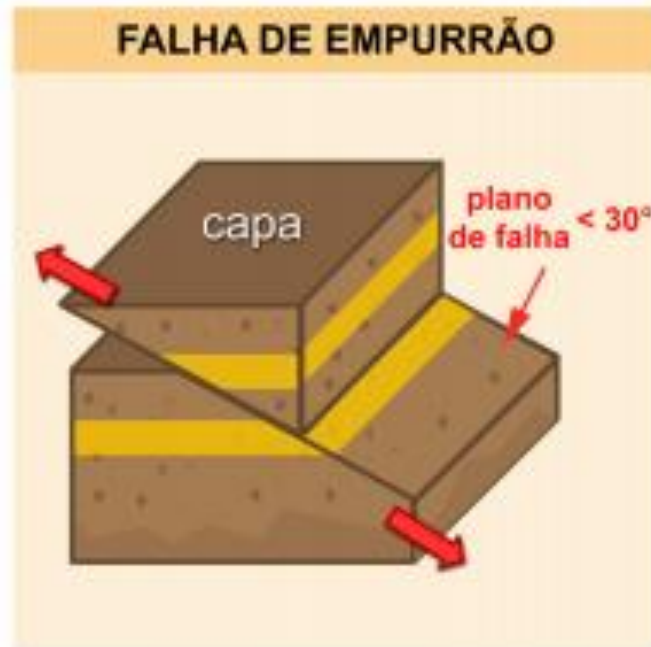
teto desloca-se por sobre o muro
