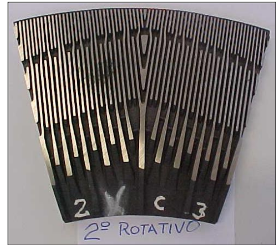
Figura 3. Ilustração de um refinador de discos (a) e fotografia de uma fração de um disco refinador (b) com as ranhuras responsáveis pela ação abrasiva sobre os cavacos de madeira.
