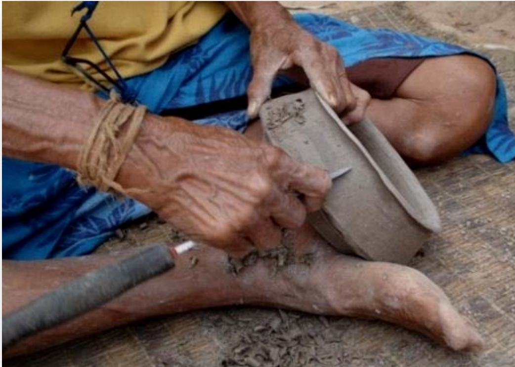
Fig. 115. Mahuederu faz a raspagem de uma tijela watxiwekyla . A raspagem é uma etapa especialmente importante na confecção de utilitários, pois é o momento em que se trabalha a forma e o volume, corrigindo imperfeições, para a obtenção de uma uniformidade na espessura das paredes das peças, prevenindo, com isso, que estas se quebrem durante a queima.
