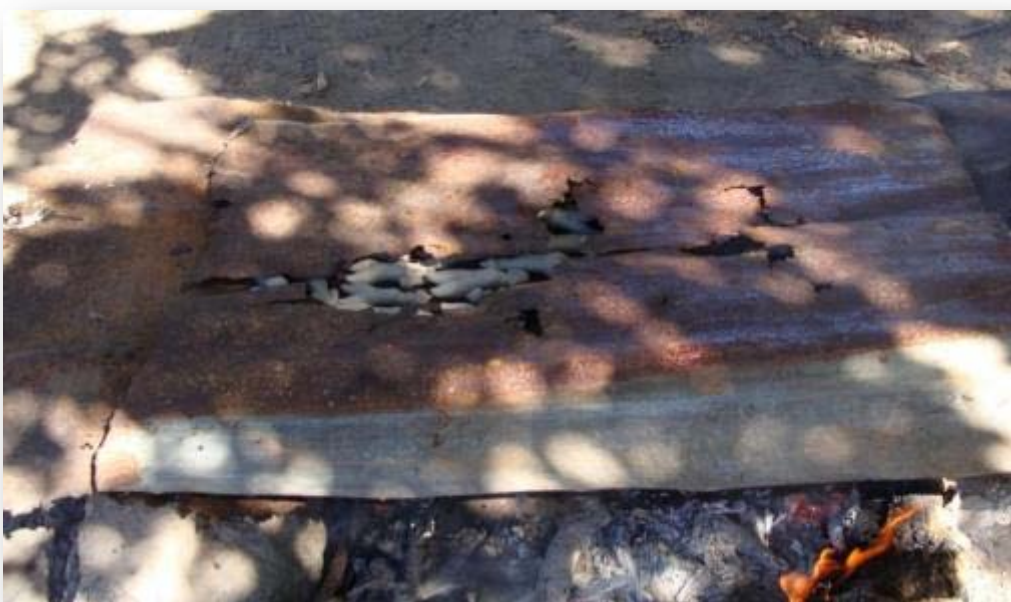
Fig. 139. Cerca de uma hora depois do início da queima, as peças são cobertas com uma outra chapa de metal, também em condições bastante precárias, enferrujada e com grandes buracos decorrentes da corrosão.
