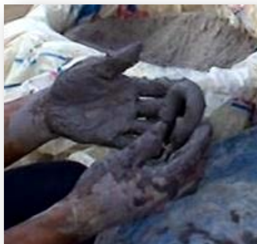
Fig.109. Técnica do rolete, usado para testar a plasticidade da liga da massa de argila.
