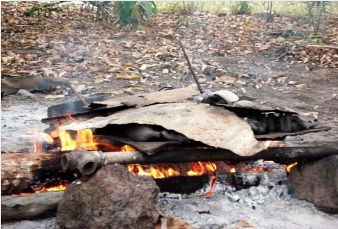
Fig. 130. Cerca de uma hora depois as peças são cobertas com outras chapas de metal, que podem ser provenientes de pedaços de cascos de "voadeiras", as lanchas comumente usadas no transporte fluvial no Rio Araguaia. O objetivo é reter o calor sobre as peças. Mais uma hora e meia na queima abafada. Myixa monitora as chamas e a distribuição do calor.
