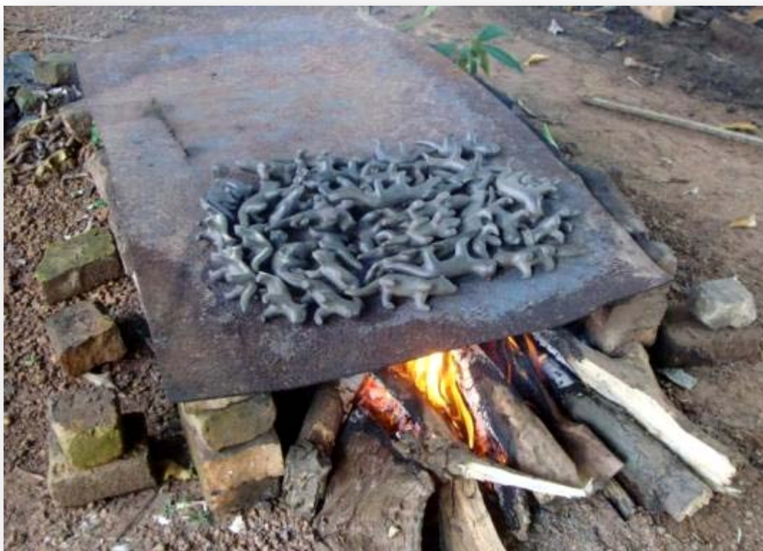
Fig. 146. As peças já escurecidas de forma homogênea são colocadas amontoadas no centro da chapa preparando-as para a segunda queima.
