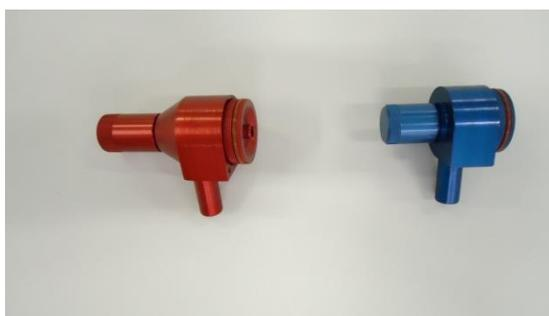
Figura 9 - Ciclone vermelho ( $10\mu\text{m}$ ) e ciclone azul ( $2,5\mu\text{m}$ )
