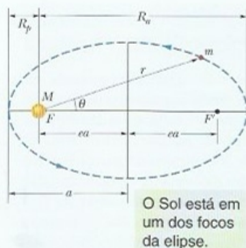
Figura 13-12 Um planeta de massa m em órbita elíptica em torno do Sol. O Sol, de massa M , ocupa um foco, F , da elipse. O outro foco, F' , está localizado no espaço vazio. Os dois focos ficam a uma distância ea do centro, onde e é a excentricidade e a é o semieixo maior da elipse. A distância do periélio R_p (ponto mais próximo do Sol) e a distância do afélio R_a (ponto mais afastado do Sol) também são mostradas na figura.
