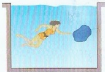
Figura 14-9 Um saco plástico de massa desprezível, cheio d'água, em equilíbrio estático em uma piscina. A força gravitacional experimentada pelo saco é equilibrada por uma força resultante para cima exercida pela água que o cerca.
