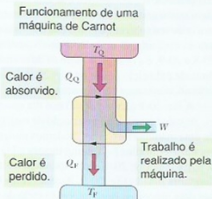
Figura 20-8 Os elementos de uma máquina de Carnot. As duas setas pretas horizontais no centro representam uma substância de trabalho operando ciclicamente, como em um diagrama p - V . Uma energia |Q_Q| é transferida na forma de calor da fonte quente, que está a uma temperatura T_Q , para a substância de trabalho; uma energia |Q_F| é transferida na forma de calor da substância de trabalho para a fonte fria, que está à temperatura T_F . Um trabalho W é realizado pela máquina térmica (na realidade, pela substância de trabalho) sobre o ambiente.
