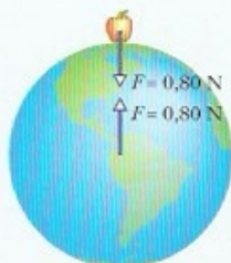
Figura 13-3 A maçã puxa a Terra para cima com a mesma força com a qual a Terra puxa a maçã para baixo.
