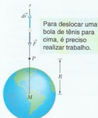
Figura 13-9 Uma bola de tênis é lançada verticalmente para cima a partir da superfície da Terra, passando pelo ponto P a uma distância R do centro da Terra. A força gravitacional \vec{F} que age sobre a bola e o vetor deslocamento diferencial d\vec{r} estão representados ao longo de um eixo radial r .
