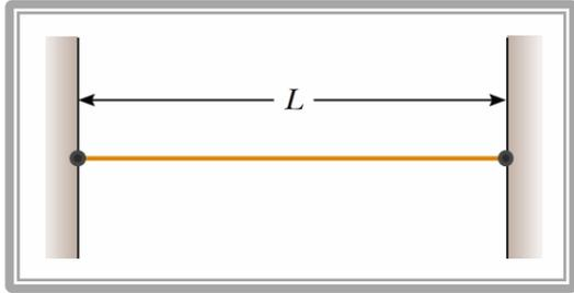
Vamos considerar uma corda de comprimento  $L$ , fixa em ambas extremidades. Ondas estacionárias podem ser geradas na corda por uma superposição contínua de ondas incidentes e refletidas nos extremos fixos. Esta corda terá um número de possíveis oscilações naturais, chamados de modos normais de vibração, cada qual com uma frequência característica.
