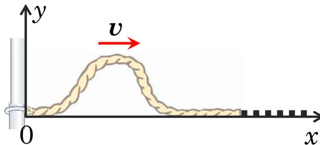
*o pulso volta sem ser invertido, depois da reflexão em 0, e sem mudança de fase*
