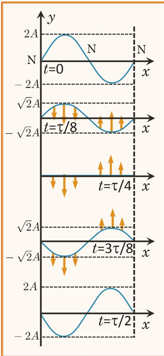
A figura mostra uma série de "Instantâneos" de uma onda estacionária: para  $t = \tau/4$  a corda passa pela posição de equilíbrio ( $y = 0$ ) e depois os deslocamentos trocam de sinal, até atingir amplitude máxima para  $t = \tau/2$ . Daí em diante os gráficos seriam percorridos em sentido inverso (de baixo para cima), até voltar a configuração inicial para  $t = \tau$ . O fluxo médio de energia, em uma onda estacionária, é nulo.
