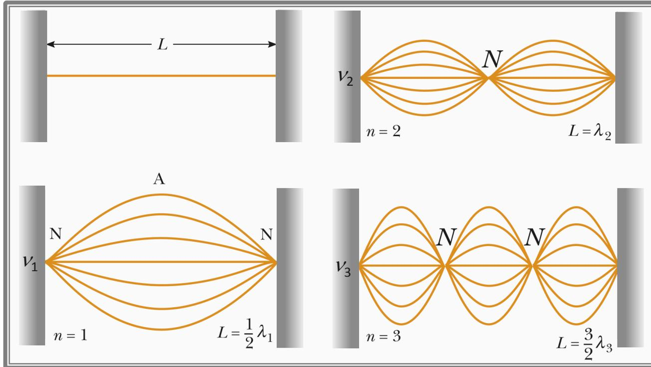
**Modo de ordem  $n$ : contém  $(n-1)$  nodos e  $n/2$  comprimentos de onda**
