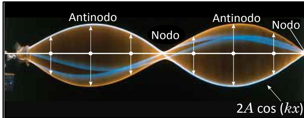
A figura mostra uma fotografia, de tempo de exposição longo, de uma onda estacionária em uma corda. O comportamento temporal de um deslocamento vertical (transversal), a partir do equilíbrio, de uma partícula individual da corda é dado por  $\cos(\omega t)$ . Isso indica que cada partícula vibra com frequência angular  $\omega$ . A amplitude da oscilação vertical de qualquer partícula depende da posição horizontal da partícula, que vibra confinada em uma função envelope  $2A \cos(kx)$ .
