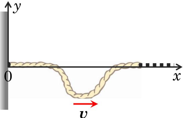
o pulso volta invertido, depois da reflexão em 0, com defasagem de  $180^\circ$
