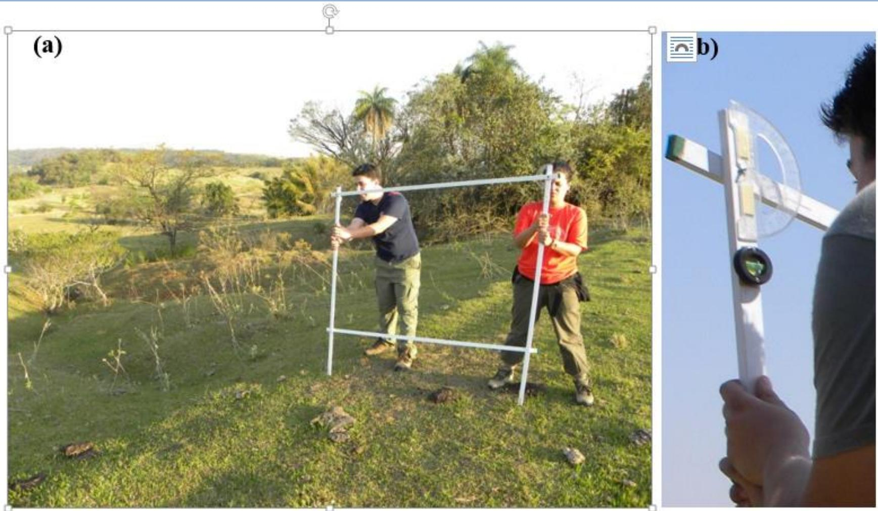
Figura 14: Exemplo da utilização do pantômetro na mensuração da declividade a montante da cabeceira de uma feição erosiva (a) e, detalhe da leitura do ângulo no transferidor e do nível de bolha (b).
