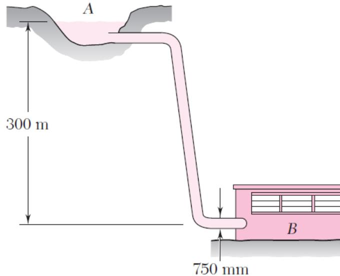
39. (Beer J.) Uma adutora de aço tem um diâmetro externo de 750 mm e conecta um reservatório em *A* com uma estação geradora de energia em *B*. Sabendo que a densidade da água é de  $1000 \text{ kg/m}^3$  e que a tensão normal admissível no aço é de 85 MPa, determine a menor espessura de parede que pode ser usada para a adutora. (Adote  $g = 9,81 \text{ m/s}^2$ )
