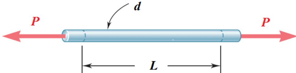
36. (Beer J.) A variação no diâmetro de um grande parafuso de aço é cuidadosamente medida enquanto a porca é apertada. Sabendo que  $E = 200 \text{ GPa}$  e  $\nu = 0,29$ , determine a força interna no parafuso, quando se observa que o diâmetro diminuiu em  $13 \mu\text{m}$ .
