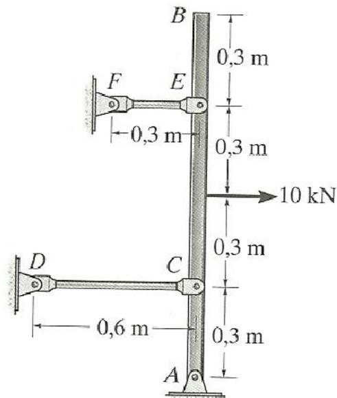
11. O elo rígido é suportado por um pino fixo em D, um arame de aço AC (com 200mm de comprimento sem deformação e área da seção transversal de  $22,5\text{mm}^2$ ), e por um pequeno bloco de alumínio (com 50mm de comprimento sem carga e área da seção transversal de  $40\text{mm}^2$ ). Supondo que o elo seja submetido à carga mostrada, determinar sua rotação em torno do pino D. Dar a resposta em radianos.
