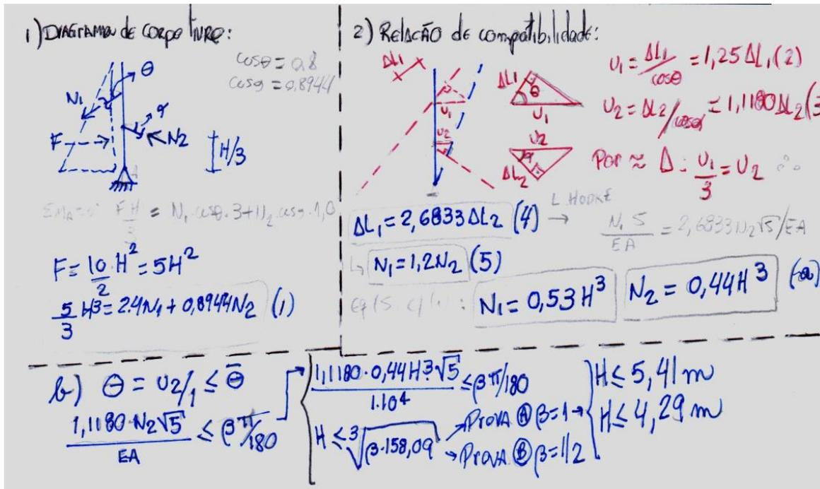
9. (Hibbeler RC) Os três cabos de aço de mesmo material mostrados na figura são acoplados a um elemento rígido por pinos. Supondo que a carga aplicada ao elemento seja de 15 kN, determinar a força desenvolvida em cada cabo. Cada um dos cabos AB e EF tem área da seção transversal de 25 mm<sup>2</sup>, e o cabo CD tem área da seção transversal de 15mm<sup>2</sup>.
