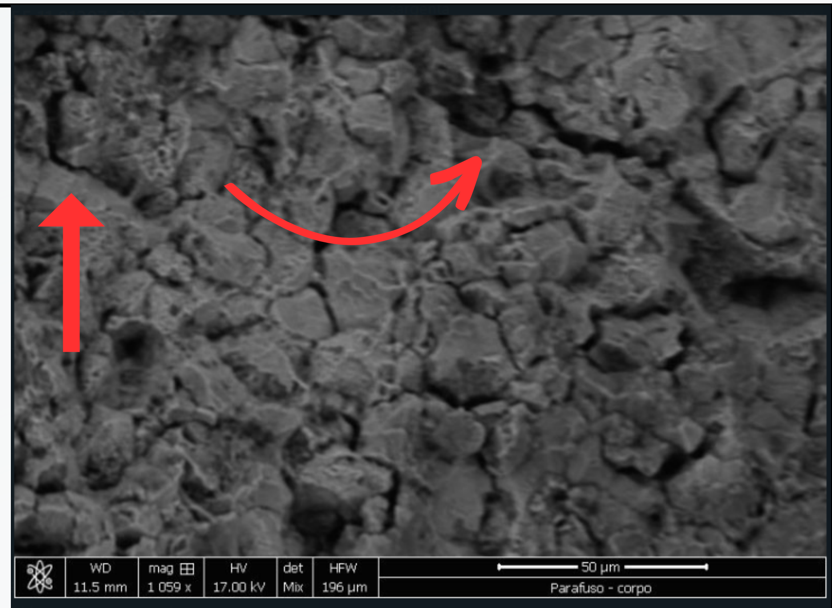
corrosão intergranular - MEV
