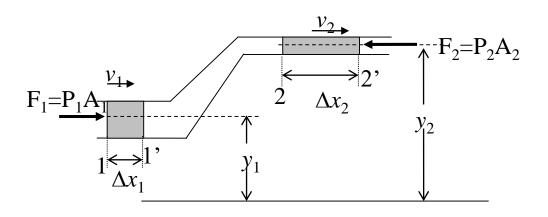
O fluido que está a esquerda do elemento de volume limitado pela área 1, exerce sobre o elemento de volume considerado uma força  $F_1 = P_1 A_1$ , sendo  $P_1$  a pressão em 1.
