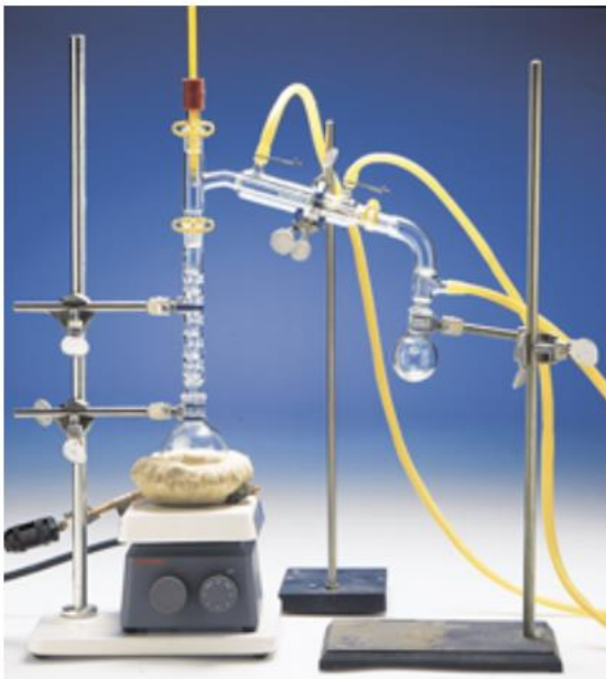
Figura 14-13 Um aparelho de destilação fracionário. A fase vapor ascendente na coluna está em equilíbrio com a fase líquida que se condensou e está fluindo lentamente de volta para baixo na coluna.
