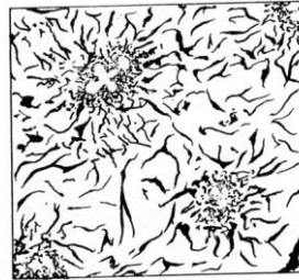
Fig. 535 — Veios de grafita do tipo B. Veios com disposição radial em torno de núcleos de aspecto esférico. 100 x.
