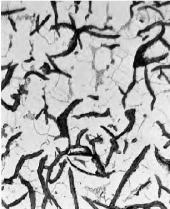
Fig. Fotomicrografia de um ferro fundido cinzento. Os flocos escuros de grafita estão encerrados em uma matriz de ferrita \alpha . 500 X.
