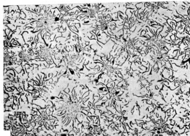
Fig. 536 — Ferro fundido cinzento, sem ataque, com veios do tipo B. 130 x.
