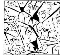
Fig. 537 — Veios de grafita do tipo C. Veios grandes e quase retos e, entre eles, veios pequenos comuns. 100 x.
