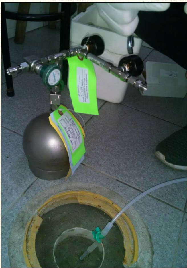
Coleta de amostra de gás em poço localizado no edifício de Transportes, utilizando amostrador tipo canister (Jul-Ago, 2015).
