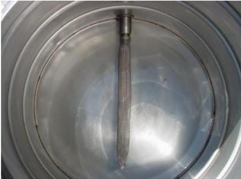
Panela de mostura e filtração com sistema 'bazuca'
