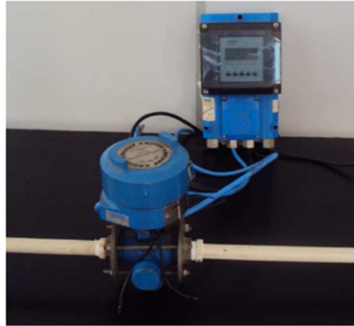
Figura 9 - Medidor de vazão para ensaios com tubos de polietileno
