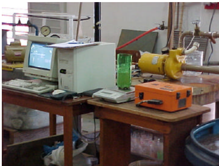
Figura 11 - Bancada experimental utilizada no ensaio dos hidrociclones, mostrando o conversor de sinal do medidor de vazão, a balança, o conjunto motobomba e o microcomputador.
