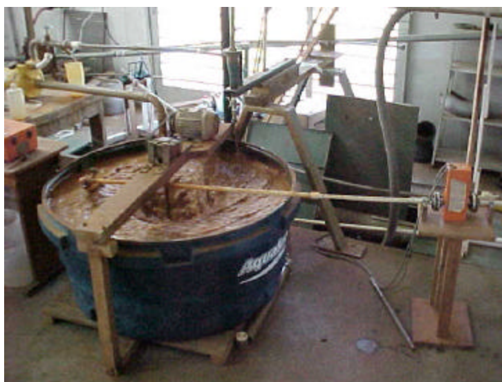
Figura 10 - Bancada experimental utilizada no ensaio dos hidrociclones, mostrando o reservatório, medidor de vazão, hidrociclone e o agitador submersível.
