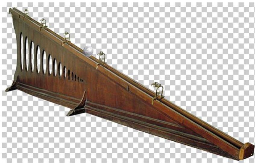
Figura 1 – Foto de uma montagem experimental muito similar àquela utilizada por Galileu para a investigação do movimento de corpos em um plano inclinado.
