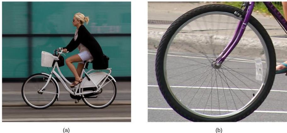
Figura 3 - (a) A bicicleta avança e seus pneus não escorregam. A parte inferior do pneu ligeiramente deformado fica em repouso em relação à superfície da estrada por um período de tempo mensurável. (b) Esta imagem mostra que a parte superior de uma roda rolante parece borrada por seu movimento, mas a parte inferior da roda está instantaneamente em repouso.
