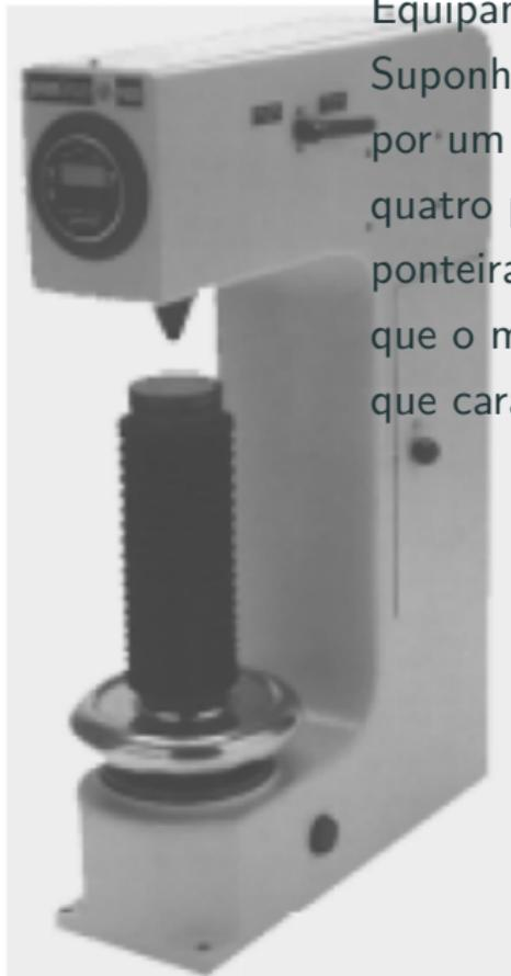
Equipamento para ensaio de dureza Rockwell. Suponha que o equipamento está sendo manuseado por um único operador e que estão sendo testadas quatro ponteiros diferentes. Nesse caso, o tipo de ponteira pode influenciar a leitura da dureza (suponha que o material submetido ao teste são diferentes, o que caracteriza blocos.)
