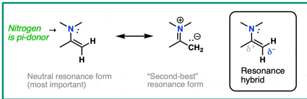
Estruturas de ressonância de uma enamina mostrando a capacidade nucleofílica do carbono conjugado, cujo culmina por atacar o iodometano ou outro carbono eletrofílico.
